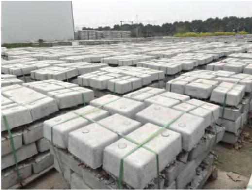
非预应力混凝土短轨枕实物图
