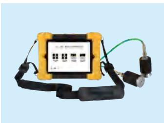
混凝土超声波检测仪
