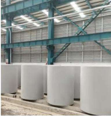
军事工程用 RPC混凝土靶板
