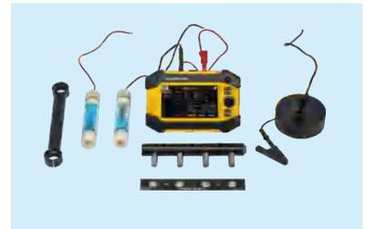
钢筋锈蚀检测仪
