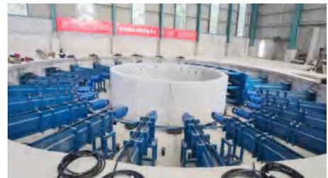
盾构管片加载试验平台
