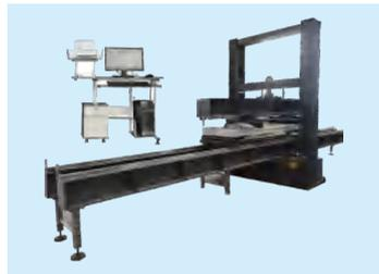
蒸压加气混凝土板材结构性能试验机
